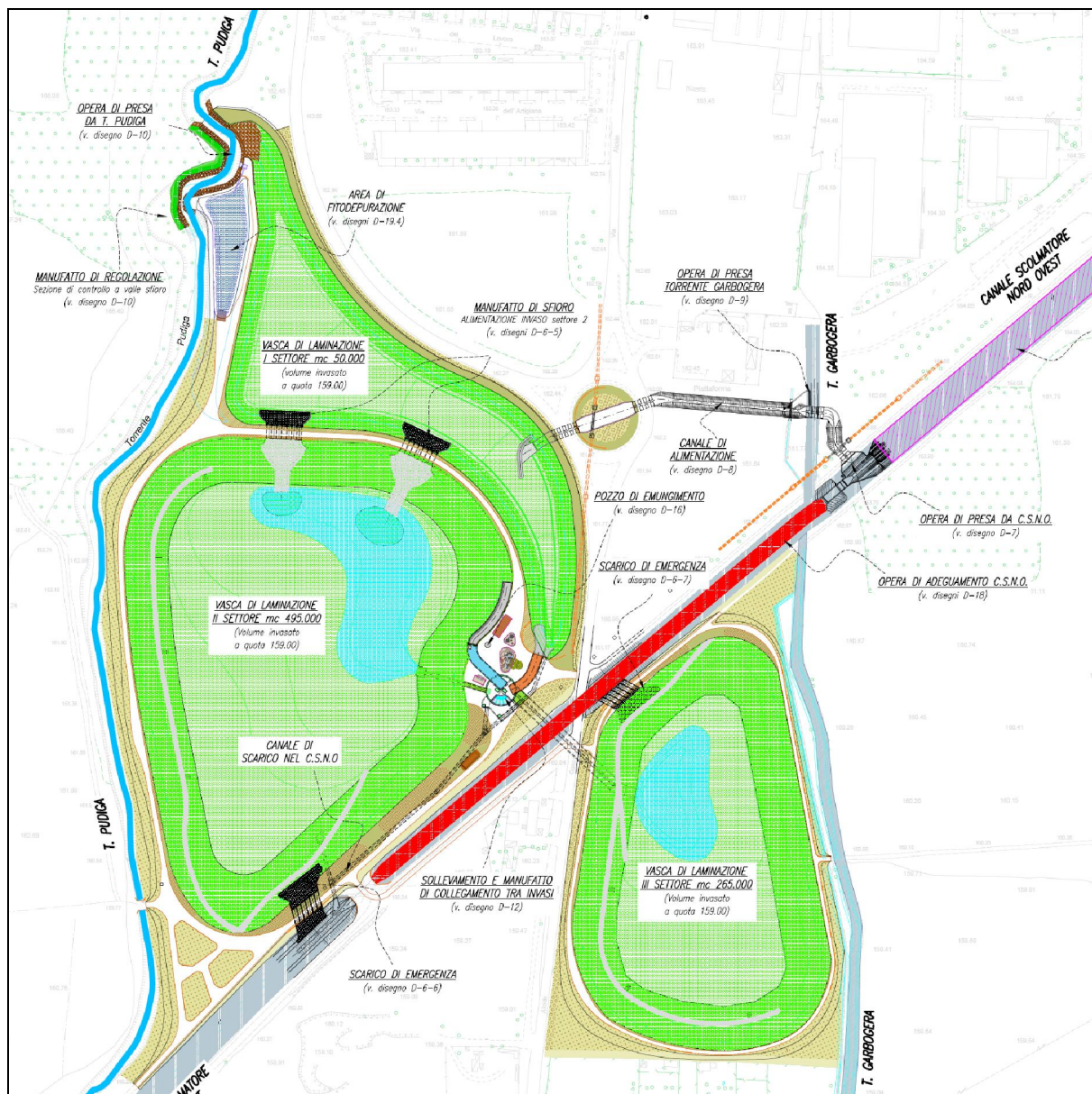
Figura 1 – Planimetria della vasca di laminazione di Senago con indicazione delle opere oggetto della progettazione definitiva.
